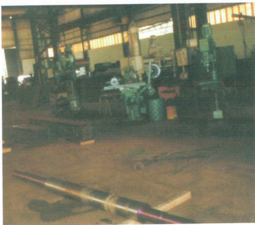
Figura 14 Furadeiras ao lado, fresadora ao centro e eixo usinado abaixo
